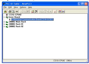
Step 3. [PLC I/O Table] 설정창에서 PLC에 설치된 통신 모듈을 더블 클릭하여 [Edit Parameters] 창에서 아래내용을 설정 합니다.
