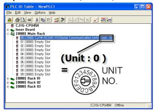
Step 3. [PLC I/O Table] 설정창에서 PLC에 설치된 통신 모듈을 더블 클릭하여 [Edit Parameters] 창에서 아래내용을 설정 합니다.
