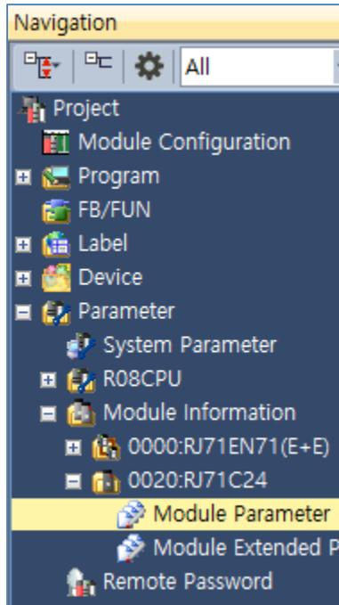
**Step 2.** [Module parameter] 창에서 [Basic Settings] 탭을 선택하여 아래 내용을 설정합니다.
