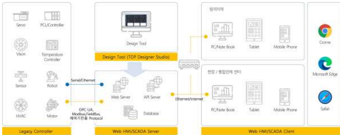
[당사 Web 기반 HMI & SCADA 제품의 시스템 구성도]
